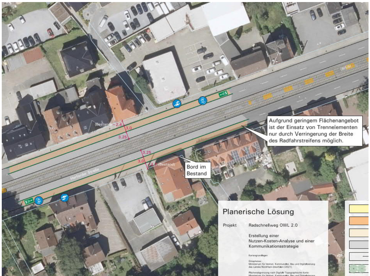
Abb. 46 Ausschnitt Planerische Lösung für einen Abschnitt der Herforder Straße, zw. Beckhausstraße und Stadtheider Straße BI111/BI56 (nicht maßstäblich, Lageplan maßstabsgetreu und mit weiterführenden Informationen im Anhang)
