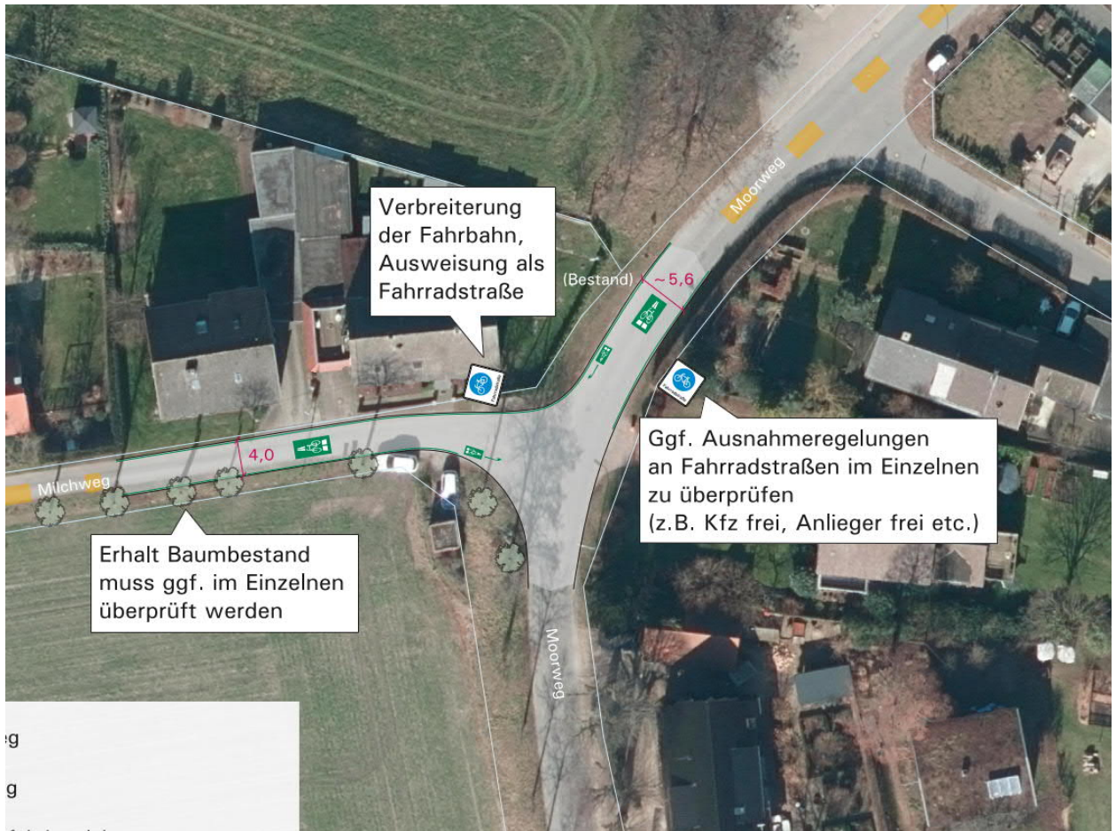
Abb. 28 Ausschnitt Planerische Lösung für den Knotenpunkt Moorweg/Milchweg, Abschnitte RW15/RW05 (nicht maßstäblich, Lageplan maßstabsgetreu und mit weiterführenden Informationen im Anhang)
