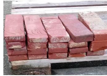
Wiederverwertung der alten Ziegel als Verblendmauerwerk
